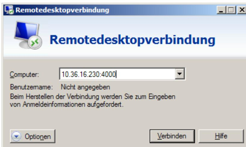
Aufruf einer RDP-Verbindung zu einem Windows-Server über einen alternativen Port.
