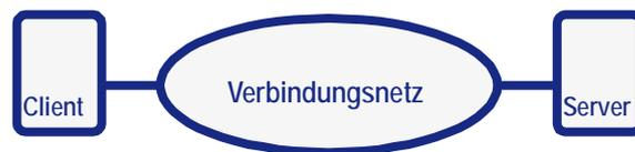
**Abbildung 1:** Jede Kommunikation zwischen zwei Computern basiert darauf, dass ein Client über ein Verbindungsnetz auf einen Server zugreift. Das Verbindungsnetz kann z. B. das lokale Netzwerk (LAN) oder auch das Internet sein.
