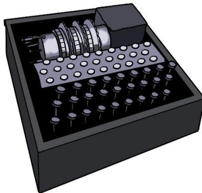
Die Enigma wurde vor allem bekannt, weil sie im zweiten Weltkrieg von der deutschen Wehrmacht zur Verschlüsselung des Nachrichtenverkehrs verwendet wurde. Sie sieht aus wie eine alte Schreibmaschine, besitzt aber drei bewegliche Walzen die miteinander verdrahtet sind. Der Schlüssel, der jedem Kommunikationspartner bekannt sein muss, setzt sich aus mehreren Faktoren zusammen, wie zum Beispiel der Auswahl der Walzen, der Reihenfolge der Montierung, der Verdrahtung oder auch der Grundstellung.
