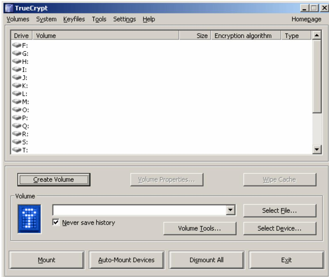
Über den Button „Create Volume“ erzeugt man mit Hilfe eines Assistenten einen verschlüsselten Container. Dieser beinhaltet später die vertraulichen Daten. Beim Einrichten eines Containers bietet Truecrypt verschiedene Optionen an:
